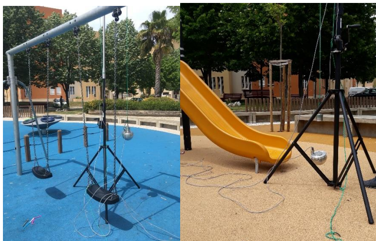
Fig. 2 – Ensaio verificação superfícies amortecedoras de impacto.
